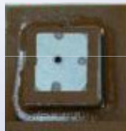
CP SMD antennas
