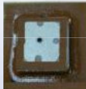
CP SMD antennas
