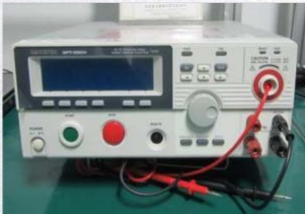
耐压绝缘测试机
