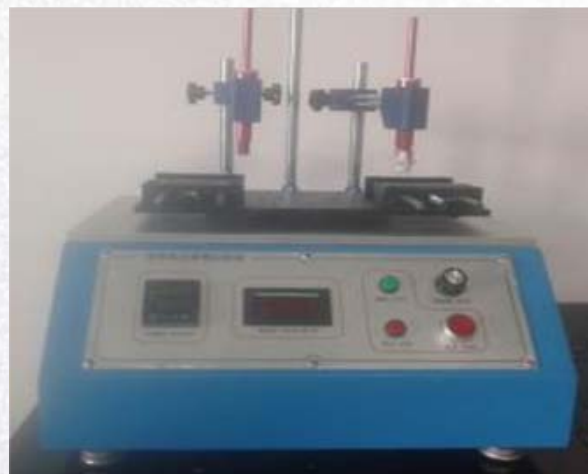
酒精橡皮摩擦测试机
