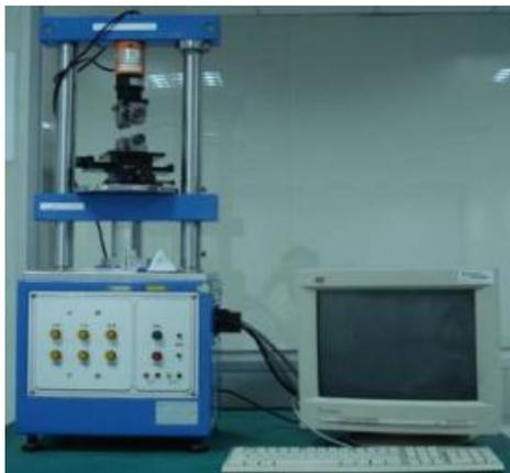
自動插拔力測試機
