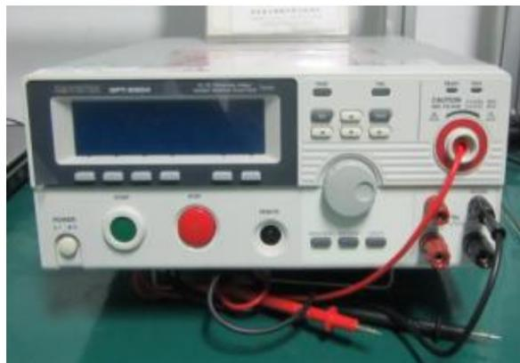
耐壓絕緣測試儀
