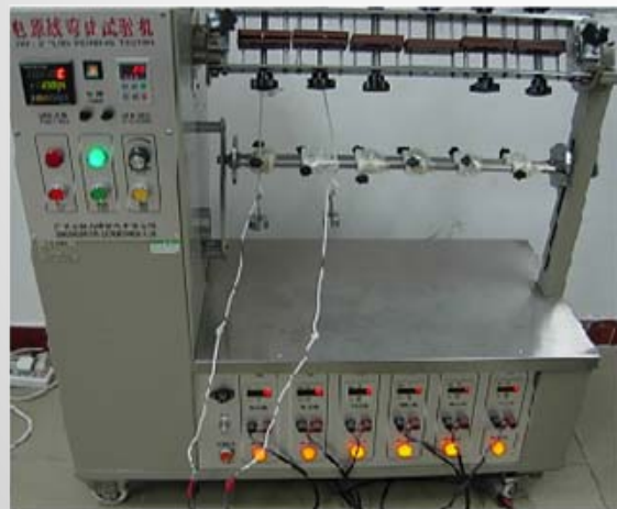
電源線彎曲試驗機 DW-2
