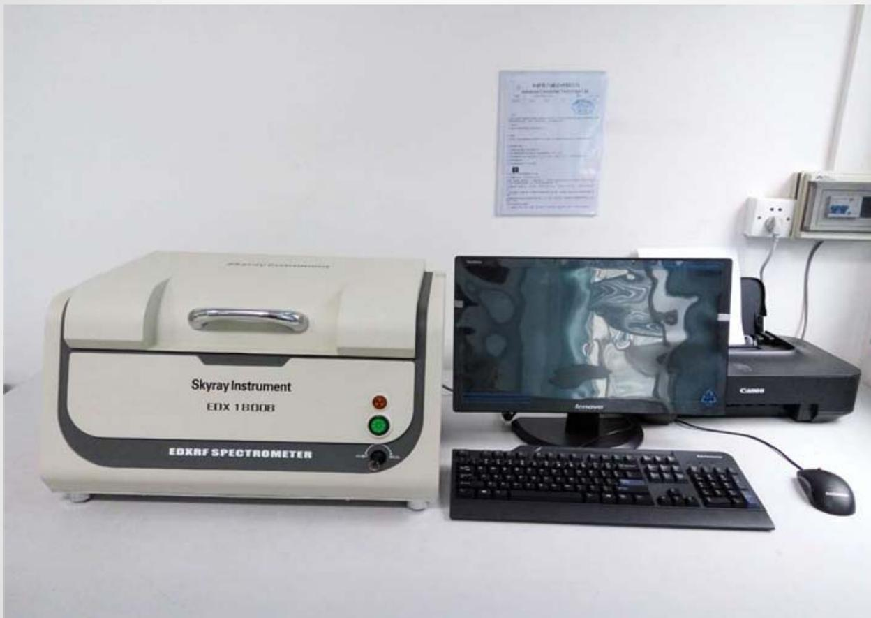
XRF 測試儀
