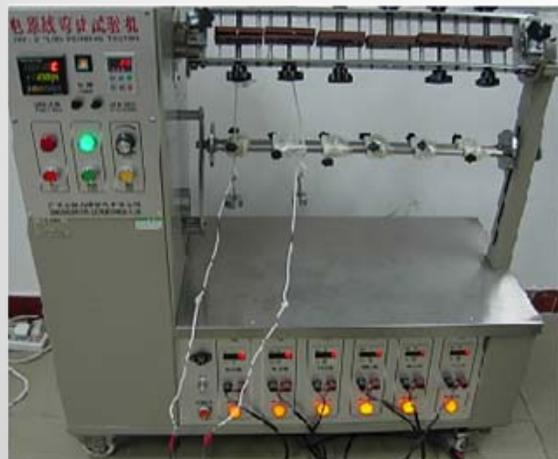
電源線彎曲試驗機 DW-2
